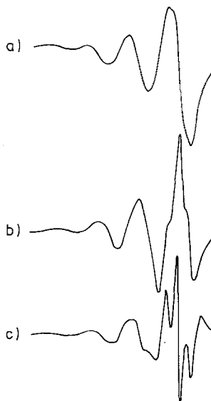
Abb. 2. EPR-Spektren von 1c ( ^{15}\text{N} ) in Toluol bei 294 K ( 10^{-3} \text{ mol l}^{-1} ); a 1. Ableitung; b 2. Ableitung; c 3. Ableitung
